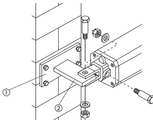
برای نصب پلیت سر جک ابتدا جک را خلاص کنید و شفت جک را به صورت کامل به سمت داخل فشار دهید سپس به اندازه ۵ میلی متر آن را به سمت بیرون بکشید. سپس جک را قفل کنید. پلیت سر جک را بر روی جک قرار داده و درب را تا زاویه مورد نظر باز کنید. جک را روی درب قرار داده و محل قرارگیری سر جک را علامت گذاری کنید. در نهایت پلیت را از سر جک جدا کرده و آن را بر روی درب قرار داده و با جوشکاری در محل مورد نظر محکم کنید.
