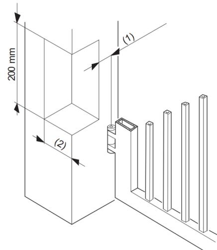
اتصال پلیت ته چک به دیوار بستگی به نوع دیوار داشته و این کار با پیچ یا جوشکاری انجام می شود. پلیت ته چک از دو بخش (۱) و (۲) در شکل زیر تشکیل شده که با جوشکاری به هم متصل می شوند. پس از نصب پایه پلیت چک را به کمک پین های مخصوص به پایه متصل نمایید.
