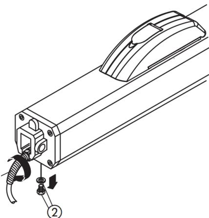
نحوه اتصال کابل برق ورودی به جک در شکل زیر نشان داده شده است.
