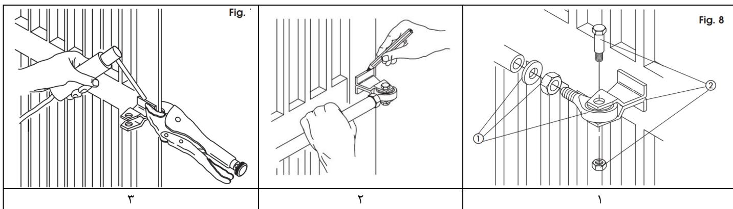
در نهایت کاور سیلندر را به کمک پیچ های مخصوص بر روی جک نصب نمایید.
